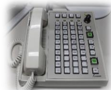
列車無線装置
