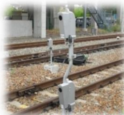
踏切障害物検知装置
